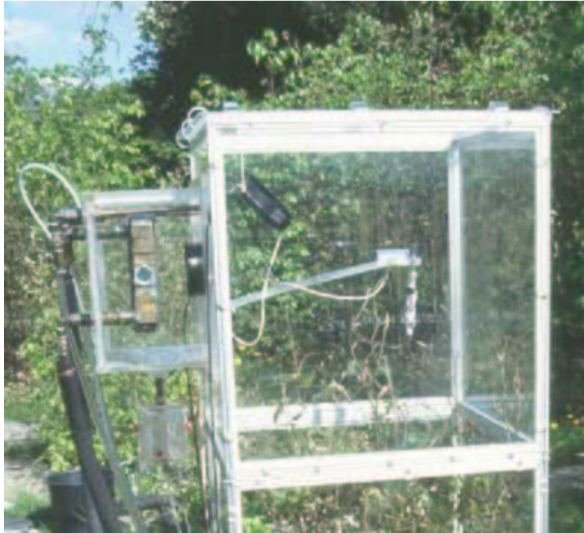
Abb. 2.13: Kühleinheit an der Rückwand (Nordseite) der Expositonskammern.
