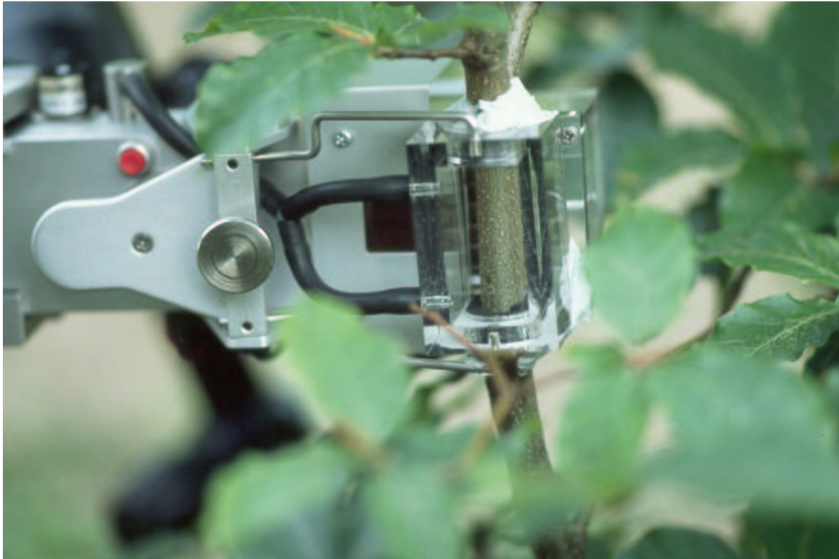
Abb. 2.23: Gaswechsellmessanlage (HCM-1000, Walz) und Spezialkammer (Sonderanfertigung) für Stammrespirationmessungen an juvenilen Buchen in der Versuchsreihe 1997-2000. Die Messkammer, die ein Stammsegment von 5.6 cm Länge und bis zu 2.5 cm Durchmesser einschließen konnte, wurde während der Messungen abgedunkelt.
