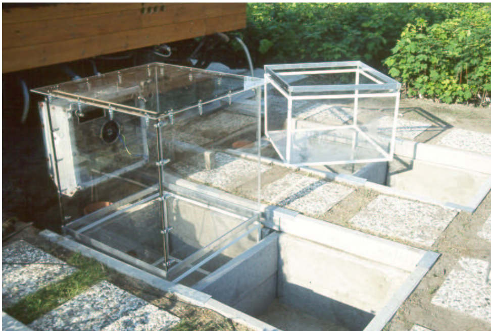
Abb. 2.12: Expositionskammern, die aus einem abnehmbaren Oberteil (Grundfläche: 80*80 cm, Bauhöhe der Elemente 40 bzw. 80 cm) und einem abgeschlossenen Unterteil (80*80*60) bestehen, wurden im Eigenbau aus UV-durchlässigem Acrylglas im Baukastenprinzip gefertigt, hier Prototyp einer Expositionskammer zu Beginn der ersten Versuchsreihe im Jahr 1991.
