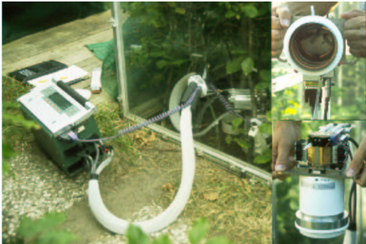
Abb. 2.24: Tragbares Gaswechsellmesssystem (LICOR 6400, LiCor) mit spezieller Bodenatmungskammer (soil \text{CO}_2 -flux chamber), das zur Messung der Bodenatmung in den juvenilen Buchenbeständen nach Wachstum bei 350 und 700 \mu\text{mol mol}^{-1} \text{CO}_2 der Versuchsreihen 1994-1999 und 1997-2000 im September 1999 eingesetzt wurde. Die Schlauchleitungen von der Messkammer (Bild: rechts oben und unten) zum Analysegerät (Bild: links) wurden durch Bohrungen der Seitenwand geführt, sodass die Messungen bei geschlossenen Expositionskammern bei jeweiliger \text{CO}_2 -Wachstumskonzentration durchgeführt werden konnten. Die Messungen wurden mit freundlicher Unterstützung von Herr Dr. habil. Klaus Waloszczyk, Professor Hellriegel Institut, Bernburg, durchgeführt.
