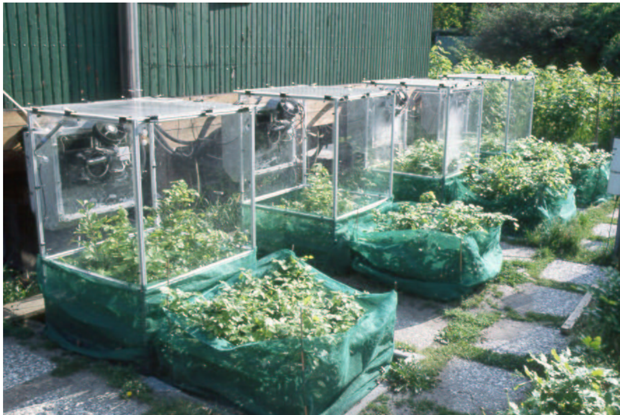
Abb. 2.4: Versuchsanlage mit vier Expositionskammern und einem Bauwagen zur Aufnahme der Mess- und Regelgeräte auf dem Institutsgelände in Berlin-Dahlem.
