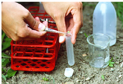
Abbildung C.5.3-4: Überführen des Rindenstückes in ein Reagenzgefäß mit 0,8ml Inkubationslösung.
