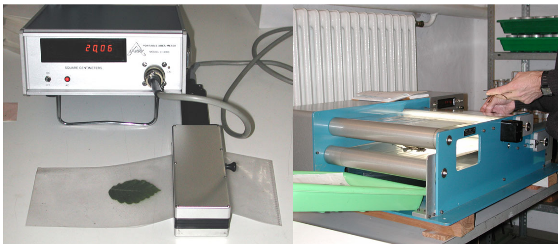
Abbildung C.1.7-1: Die direkten Messungen der einfachen Blattfläche werden mit Hilfe der Blattflächenmessgeräte (Links: Portable Area Meter, Modell LI-3000, LiCor, USA) und (Rechts: Modell Li-3100, LiCor, USA) durchgeführt.
