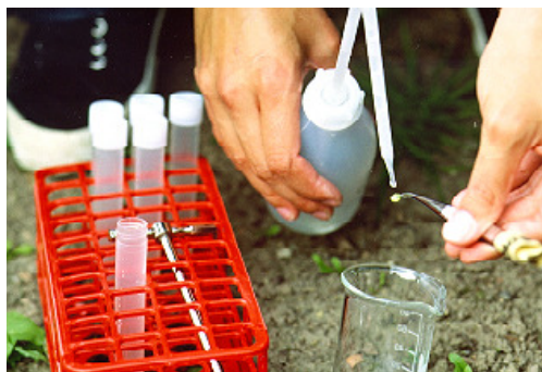
Abbildung C.5.3-3: Abspülen des Rindenstückes mit EDTA-Lösung.
